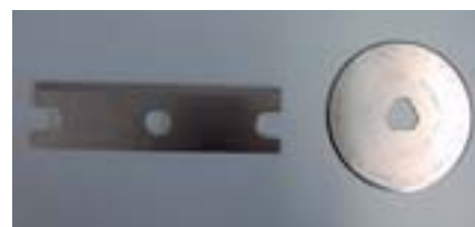
Abb. 5: Klingen für die Prüfung der Schnittfestigkeit nach ISO 13997 (links) und EN 388 (rechts)
