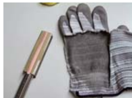
Abb. 4: Vorbereitung des Prüflings: Der Prüfling wird mit doppelseitigem Klebeband am Probenträger befestigt, wobei zwischen Prüfling und Probenträger ein Stück elektrisch leitendes Kupferband angebracht wird.
