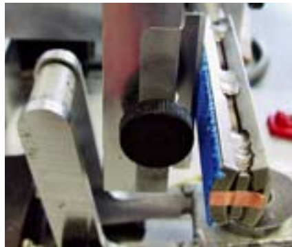
Abb. 8: Prüfung der Schnittfestigkeit nach ISO 13997: Der Schnitt des Prüflings erfolgt vertikal, wobei der Prüfling mit unterschiedlicher Kraft belastet wird. Die Detektion des Durchschneitens erfolgt durch den elektrischen Kontakt der Klinge mit dem Probenträger.
